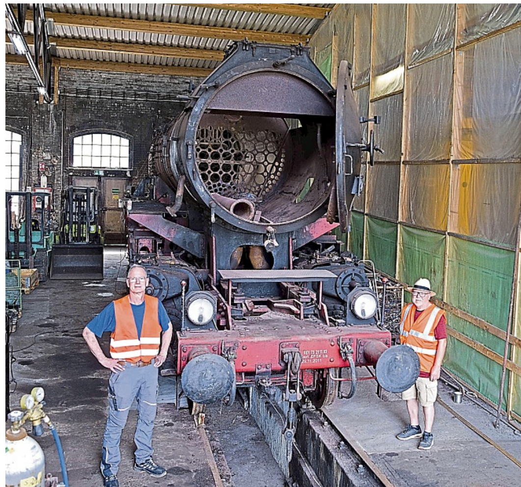
Die vereinseigene Dampflokomotive 52-8106 mit Blick in den Kessel durch die offene Frontklappe: eine Mammutaufgabe für die EFT um die Vorstandsmitglieder Andreas Ranft (links) und Karl Bubenheim.
